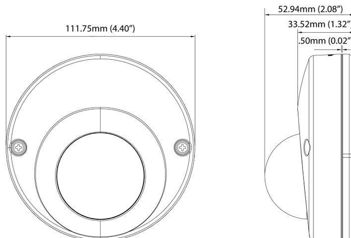
**Figura 50 Dimensiones físicas de la cámara minidomo compacta (mm)**
